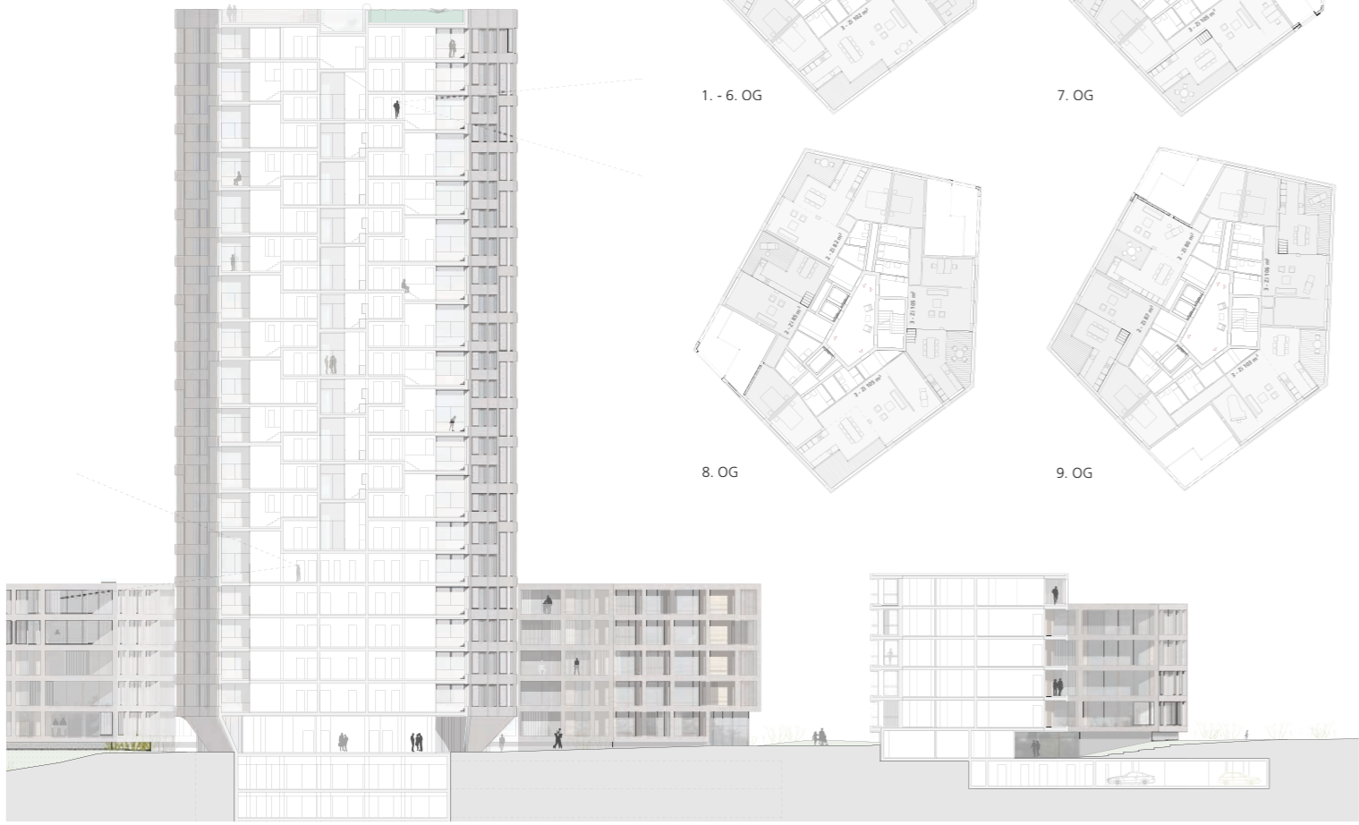
Prinzipschema Hochhaus mit 1.5-geschossigen Wohnungen
